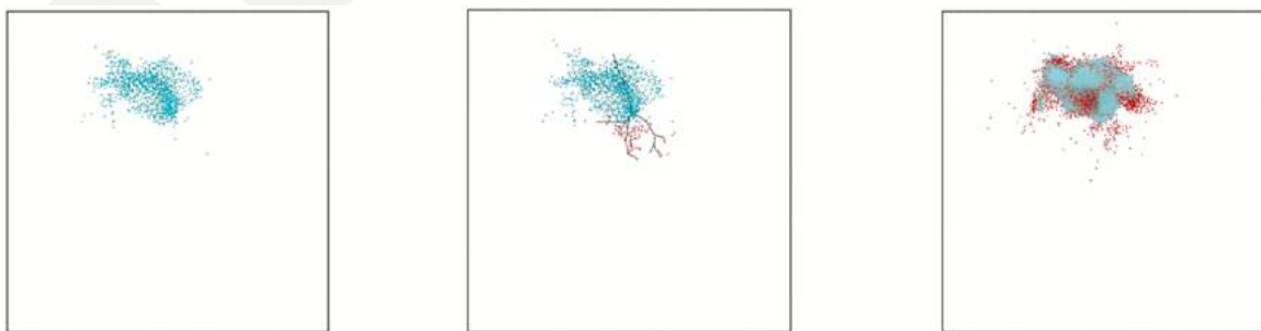
(a) 第一个 4 个原子弹击原子(PKA)产生的点缺陷(蓝色)组成的球形区域。(b) 第 5 个原子弹击原子(PKA)穿过了这个球形缺陷区域(蓝色),并在更深处产生了新的缺陷(红色)。黑线表示的是第 5 个原子弹击原子激活过程中能量原子的迁移路径。(c) 后续 8 个原子弹击原子穿过了这个球形区域(蓝色)。新产生的缺陷为红色。
